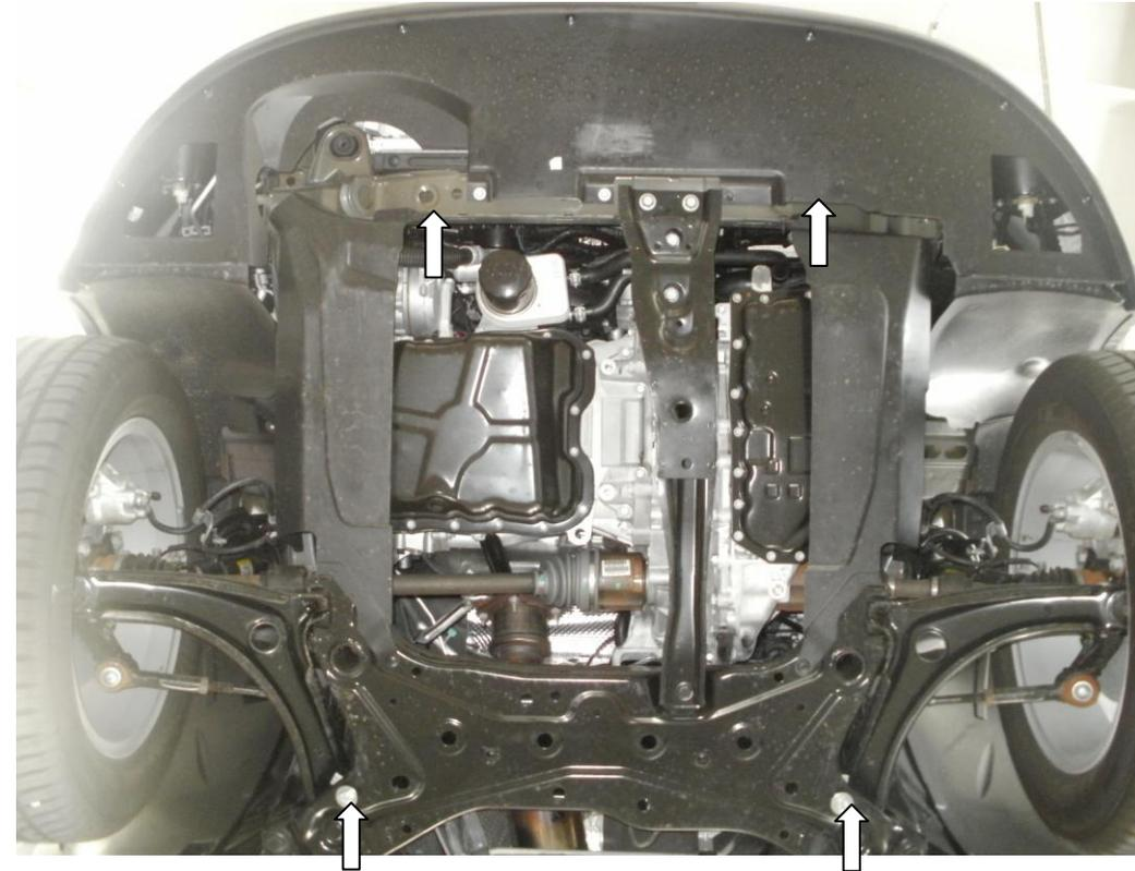
1. Завести планки 9 в крайние отверстия балки радиатора и закрепить балку 2 болтами 5(подрезавши пластиковый пыльник), рис.1,2.
