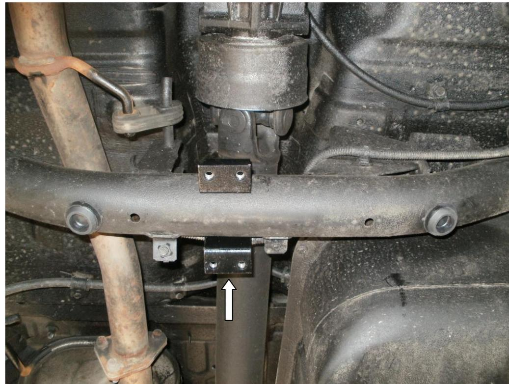
1. Наложить кронштейн 2 над круглой поперечной балкой автомобиля, рис.1
